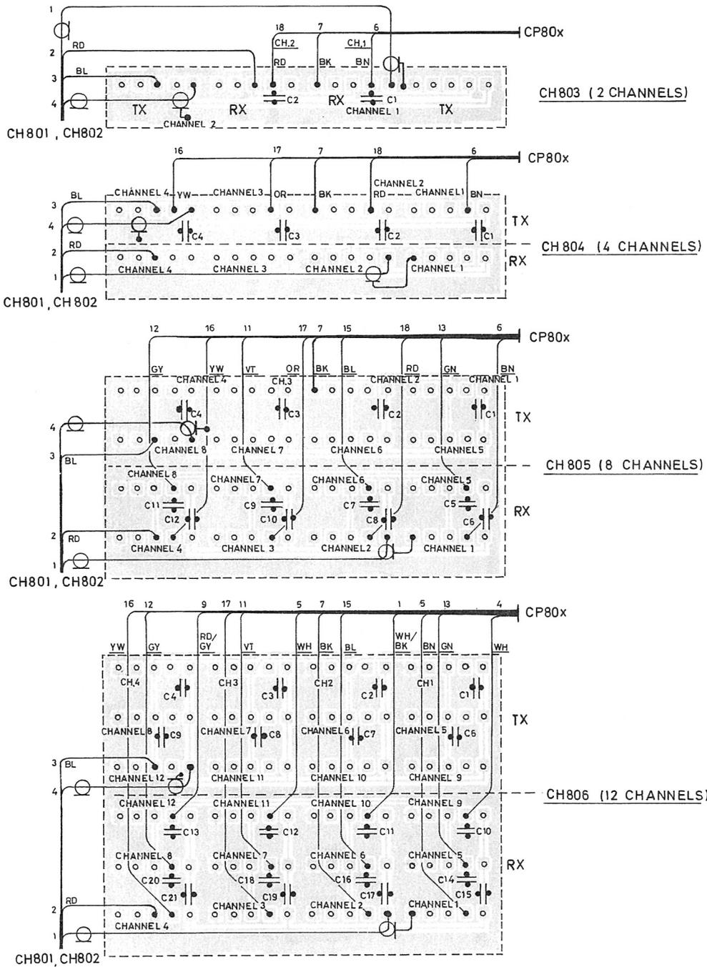
WIRING DIAGRAM CH803, CH804, CH805, CH806
