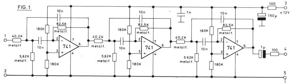
Det her beskrevne filter er tiltænkt SSB-mellemfrekvensenheden MD 502, men kan uden ændringer bruges i forbindelse med andre konstruktioner. Da filteret har 1 gangs forstærkning samt en høj indgangsimpedans, vil det ikke give forstyrrende ind i andre kredsløb.
